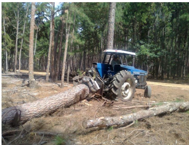
Ilustración 11. Extracción de fustes con grapa forestal. UOVN.
