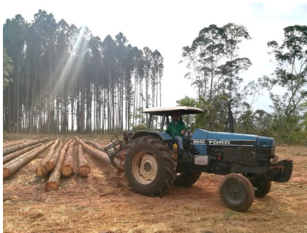
Ilustración 11. Extracción de fustes con grapa forestal. UOVN.
