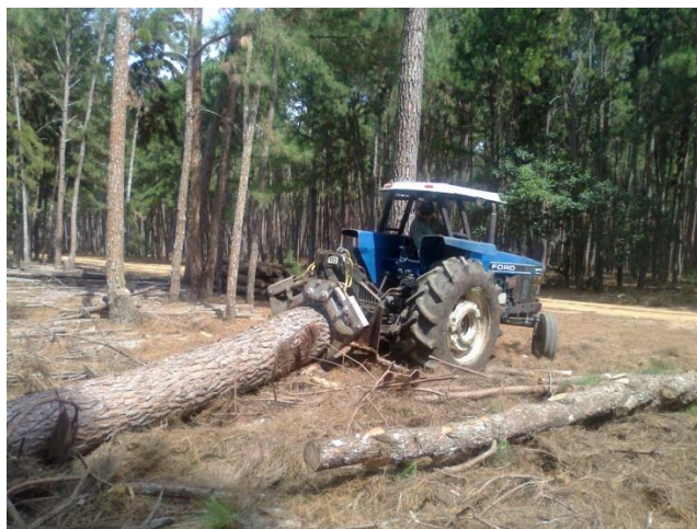
Ilustración 11. Extracción de fustes con grapa forestal. UOVN.
