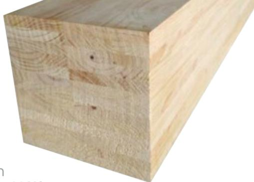
Elementos estructurales para la construcción, elaborados con madera de Pino, seca en horno al 12%, compuestas de madera maciza empalmada a través de tecnología **Finger Joint**. Las vigas de madera laminada, son resistentes a la carga y tienen un alto valor estético por lo cual generalmente son usados como elementos estructurales a la vista.
